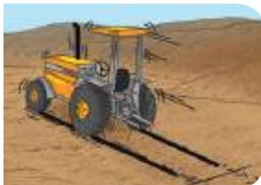
Em alguns modelos de tratores, mesmo com a tração desligada, ao acionar os pedais de freio de forma conjugada, a tração será automaticamente acionada, frenando também o rodado dianteiro, garantindo maior eficiência e segurança da frenagem em transporte.
