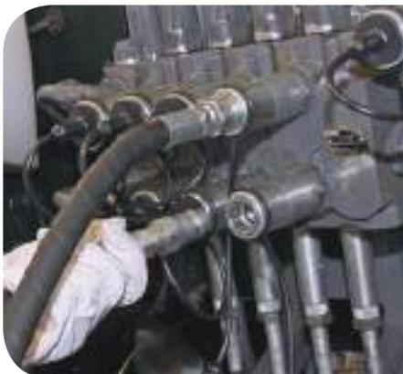
O acoplamento das mangueiras é feito empurrando o engate rápido (macho) nas conexões (fêmea) até ocorrer o travamento. O desacoplamento é feito puxando o engate rápido (macho). Este sistema é chamado de *Push/Pull* (Empurre/Puxe).
