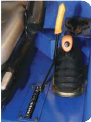
O acionamento eletro-hidráulico é feito por um interruptor elétrico que, através de solenoide, aciona o comando hidráulico, que manda o óleo sob pressão para o pacote de discos.
