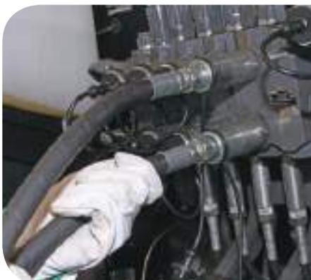
Antes de desacoplar as mangueiras da VCR, desligue o motor e movimente as alavancas para frente e para trás até perceber que o cilindro remoto não exerça mais força.
