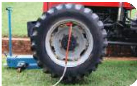
e) Retire a mangueira quando a água atingir o nível do bico.
