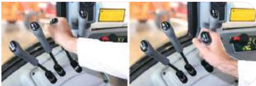
Com o motor do trator em funcionamento, as alavancas do comando devem ser acionadas somente se as mangueiras estiverem acopladas.
