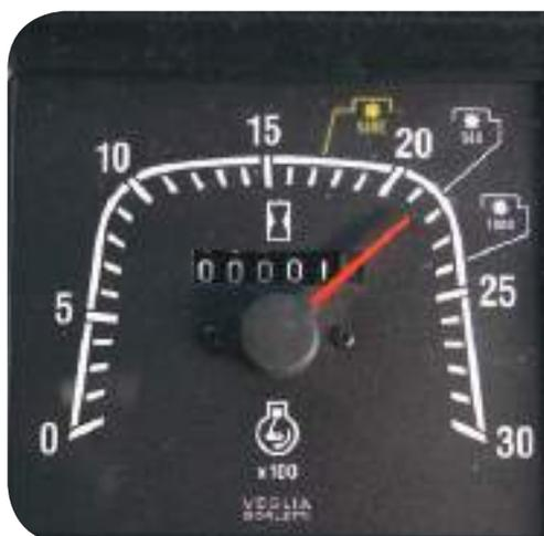
Alguns modelos mostram a rotação da TDP em sistema digital diretamente no painel do trator.
