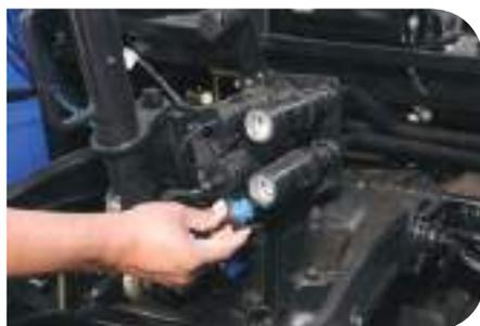
Inspeccione os anéis de vedação do engate rápido. Se houver vazamento, substitua-os.
