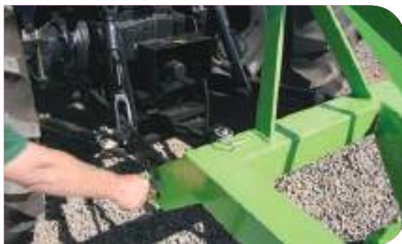
Alguns tratores possuem essa alavanca ou interruptor externo para acionamento do sistema hidráulico.
