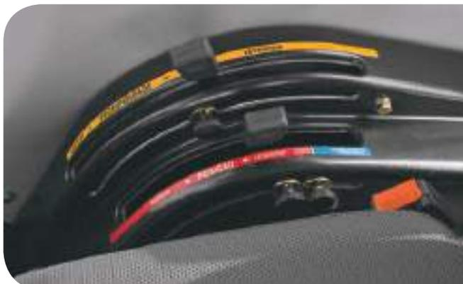
O sistema hidráulico de três pontos possui controles com funções distintas de acordo com o tipo de implemento a ser utilizado. Esses controles variam com a marca, modelo e nível tecnológico do trator, porém, de maneira geral, pode-se enumerar os controles de posição, profundidade, sensibilidade e de velocidade de descida.
