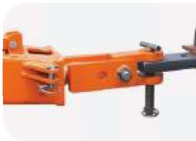
Com o cabeçote na barra de tração o pino passará por quatro furos. Neste caso, como a boca de lobo do implemento é basculante irá existir flexibilidade no sentido longitudinal do conjunto trator implemento não causando nenhum dano.
