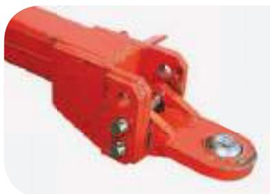
Na barra de tração reta ou com degrau, pode ser parafusado o cabeçote para formar a “boca de lobo”. Este cabeçote deve ser retirado da barra de tração em algumas situações, fazendo diferentes combinações.
