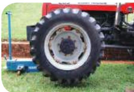
c. Retire a válvula do bico e deixe sair o ar que estava sob pressão.
