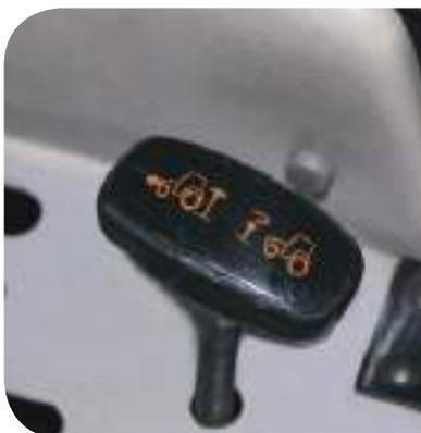
O acionamento eletro-hidráulico pode ser feito com a máquina parada ou em movimento, sem uso da embreagem.
