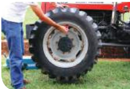
d. Coloque água no pneu.
