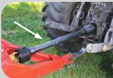
2. Mantenha a capa de proteção no eixo quando não estiver utilizando a TDP.
