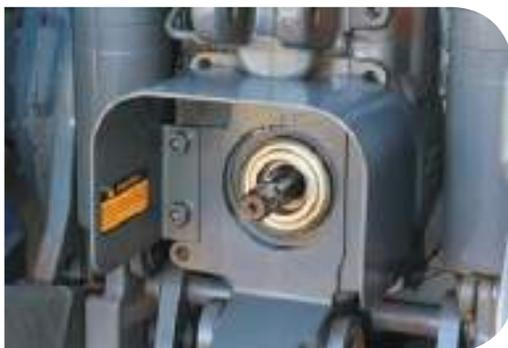
A rotação necessária no motor para gerar 540 rpm na TDP varia de acordo com a marca, modelo e ano de fabricação do trator. Esta informação é obtida no tacômetro ou em adesivos, ou ainda no manual do operador.
