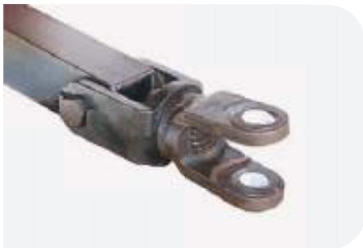
c. Cabeçalho com furo único de engate giratório e basculante.
