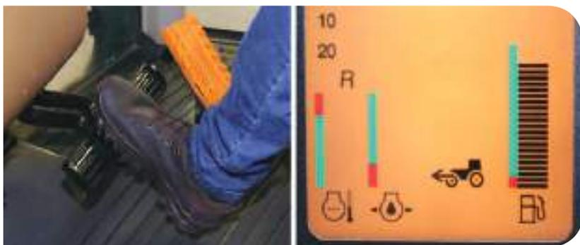
Os tratores 4x4 com chassi articulado possuem sistema de freios nas quatro rodas ou sistema central que frena as rodas através da transmissão, sendo acionado por apenas um pedal.
