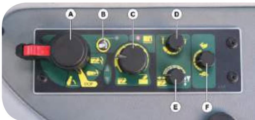
No sistema hidráulico de três pontos eletrônicos, o controle de sensibilidade dá-se por meio dos pinos oscilantes (*stream gauge*) das barras inferiores de acoplamento, que lêem o esforço de tração do trator, sendo regulada a sensibilidade no painel, através de botão giratório.
