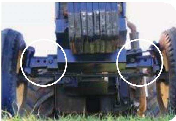
No rodado dianteiro dos tratores 4 x 2 com tração dianteira auxiliar (TDA), o sistema utilizado é o de aros e discos.
