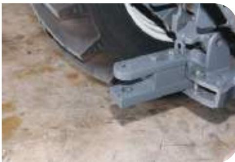
Quando a barra for regulada totalmente recuada no seu comprimento, o operador deverá estar atento nas curvas ou manobras, pois o cabeçalho ou lança do implemento poderá atropelar os pneus do trator ou danificar as mangueiras do controle remoto.
