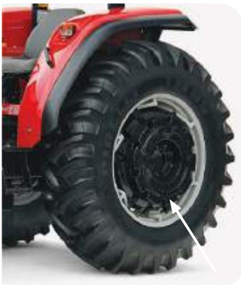
No rodado dianteiro dos tratores 4 x 2, o sistema utilizado é o de barras telescópicas presas por parafusos.
