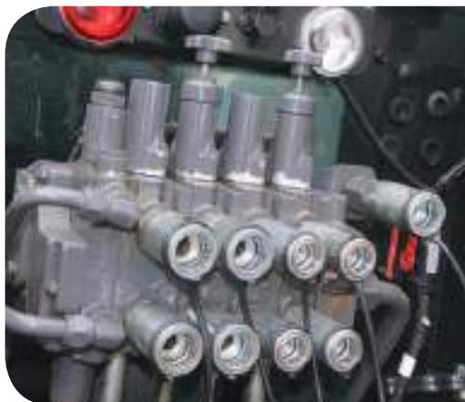
Algumas VCRs possuem em seu corpo um regulador de vazão para atender à demanda de óleo do cilindro ou motor hidráulico do implemento. Esta regulagem é feita em uma manopla giratória, localizada na parte de cima da VCR e é indicada pelos símbolos tartaruga e lebre.
