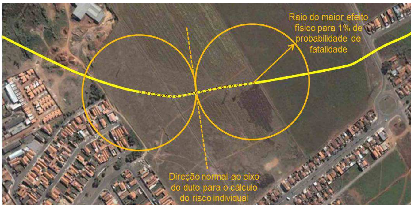
Figura 16 – Representação dos pontos de liberação a cada 10m para o cálculo do risco individual
