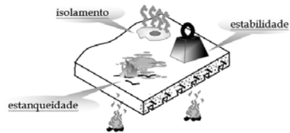
FIGURA 21 - Propriedades de resistência ao fogo de elementos de compartimentação (lajes, paredes, portas corta-fogo etc.)
