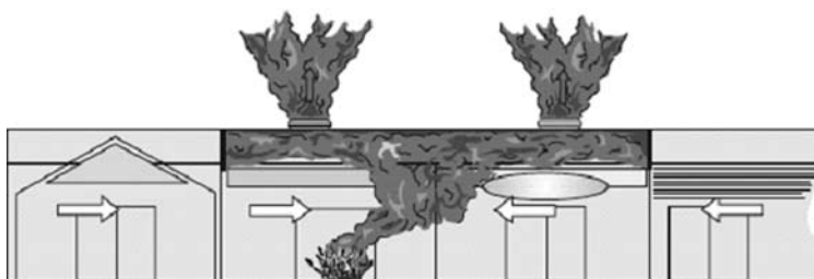
Figura C. A fumaça sai por meio das aberturas dessas zonas
