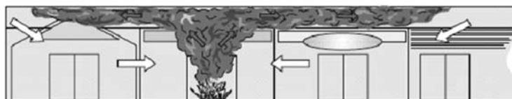
Figura A. A fumaça começa dentro de uma loja e se dispersa no shopping. A fumaça começa a subir. As setas brancas mostram o movimento do ar deslocado
