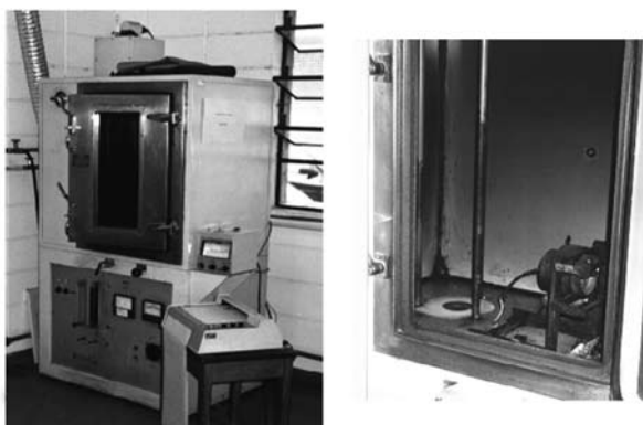
FIGURA 6 - Equipamento de ensaio para a determinação da densidade ótica específica da fumaça e detalhe da câmara de combustão
