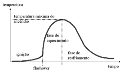
FIGURA 22 - Curva temperatura-tempo de um incêndio real
