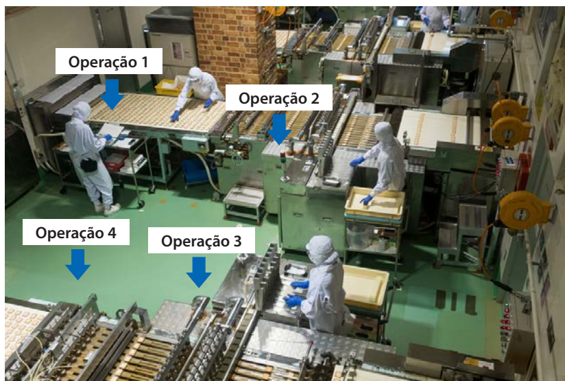
Figura 10: Layout celular e postos de trabalho em célula. Fonte: Adaptado de imagem de https://www.shutterstock.com .
