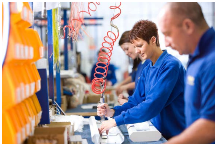
Figura 3: Parafusadeira elétrica - destaque para o cabo, fornecendo suporte vertical. Fonte: https://www.shutterstock.com .
